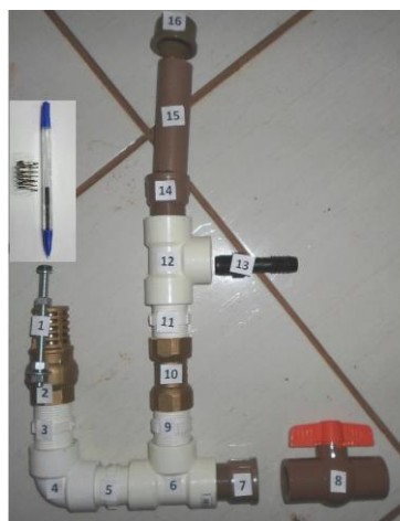
Esquema de montagem do carneiro
